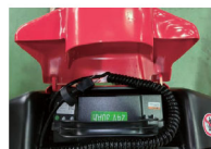
バッテリーは容易に脱着が可能（バッテリー重量10kg）
