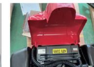
バッテリーは容易に脱着が可能（バッテリー重量14kg）
