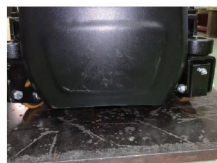
カバーと床の隙間は55mm
