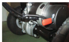
ブレーキ解除レバー レバーを操作すると電磁ブレーキが 解除され手で移動させることが 可能です。
