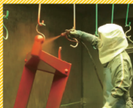
脱脂→塗装→乾燥を行い完成まで2時間~2時間半
