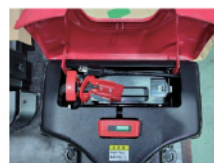
バッテリーは軽量 (5kg) で脱着が容易
