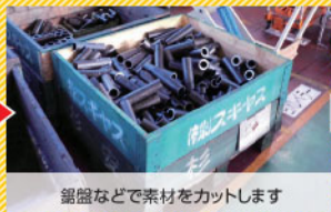
鋸盤などで素材をカットします
