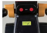
バッテリー残量がひと目でわかるインジケーター付き
