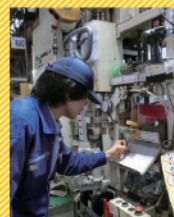
油圧ユニットの 自然降下量を検査
