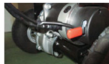
ブレーキ解除レバー レバーを操作すると電磁ブレーキが 解除され手動で移動させることが 可能です。
