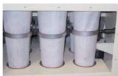
自動リフレッシュ機構とターパ型フィルター
