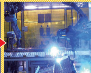
複数のロボットで溶接します。
