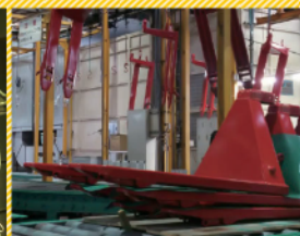
脱脂→塗装→乾燥を行い完成まで2時間~2時間半
