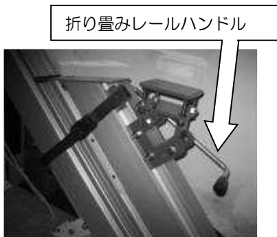
図1-3② レールの固定
