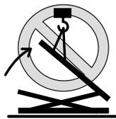
本機を移動する際にはテーブルを吊り上げての移動はしないでください。テーブルの片側が持ち上がり危険です。運搬の際には必ずベースから持ち上げてください。
