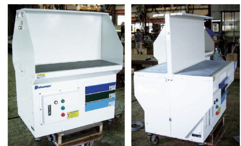
フードを取付けて作業スペースを2分割しました。
