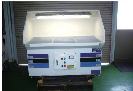
フードにLEDを取付け作業場が明るくしました。
