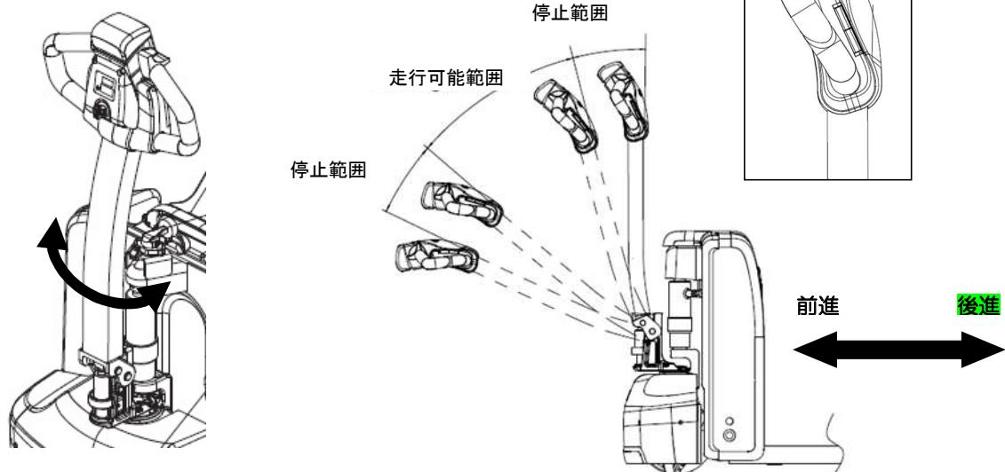
③ 操作レバーを前進もしくは後進方向に回すことで走行します。操作レバーを回す角度が大きいと速度が速くなります。（左右のレバーは連動します）
