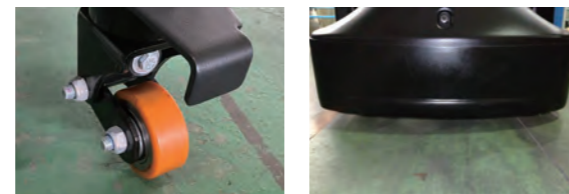
補助車輪 カバーと床の隙間は35mm
