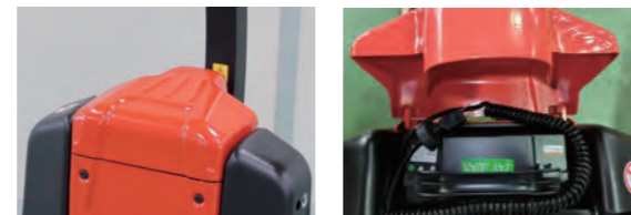
フタが付いてバッテリーをほこりなどから保護 バッテリーは容易に脱着が可能(バッテリー重量10kg)
