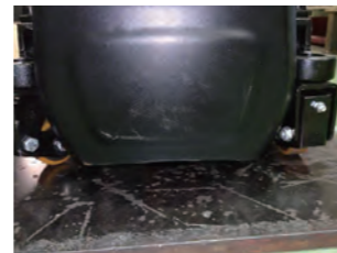
カバーと床の隙間は 55mm
