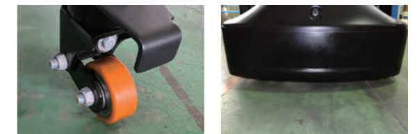
補助車輪 カバーと床の隙間は35mm
