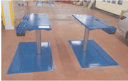
リフト使用時、フラットキットによって床とフラットな状態になります。
