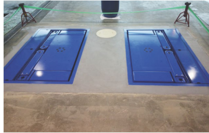
リフト上部は、床の中にスッキリ納まった状態で停止します。
