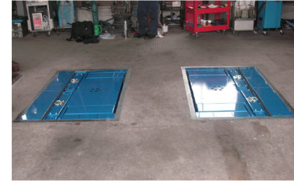
リフト上部は、床の中にスッキリ納まった状態で停止します。
