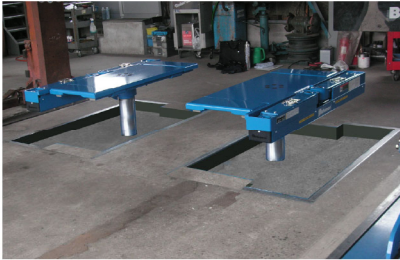
リフト使用時、床にピットの穴が開いた状態になります。
