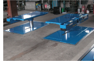
リフト使用時、フラットキットによって床とフラットな状態になります。
