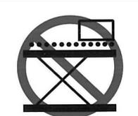
テーブルを拡大したり大きな鉄板、コンベア等を取り付けないでください。偏荷重によるリフターの破損や転倒から事故を発生する可能性があります。
