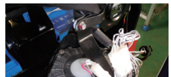
ドライブホイールはブラシレスモーターを使用しメンテナンスの軽減。
