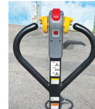
レバー操作で走行速度の調整が可能
