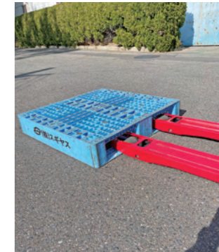
樹脂パレットへスムーズにフォークの抜き差しを行う事ができる。
