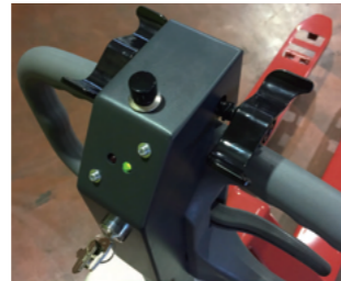
レバー操作で走行速度の調整が可能
