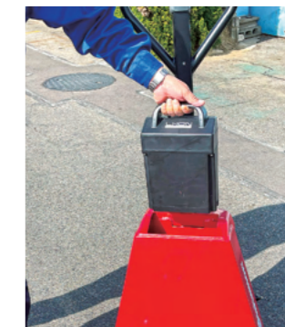
重さ5kg。片手でのバッテリー交換が可能なりチウムイオンを採用
