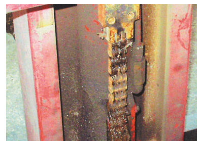
キンクした状態（棒状に固まった状態）
