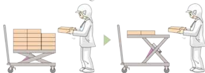
バネ構造によって、荷物を取っても載せても自動的に昇降します。
