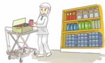
油圧の働きで荷物を持ち上げます。
