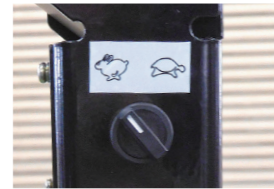
速度切り替えスイッチ 走行速度を2段階 切り替える事ができます。
