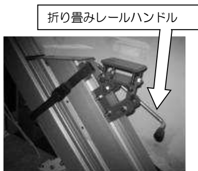
図1-3② レールの固定
