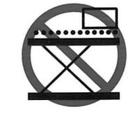
テーブルを拡大したり大きな鉄板、コンベア等を取り付けしないでください。偏荷重によるリフターの破損や転倒から事故が発生する可能性があります。
