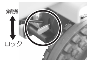
モーターブレーキ解除レバー（赤色） ※上図はロック状態
