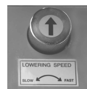
ローリングスピードバルブ ※ニュートラル（標準速度）位置
