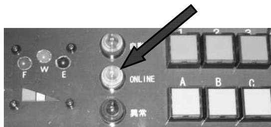
※ 走行ライン上への移動は搬送車をできるだけガイドテープと平行にして ONLINE ランプを点灯させてください。
