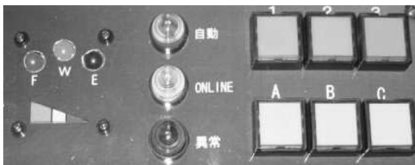
自 動・・・手動自動切換えスイッチを自動にすると点灯します。
