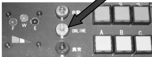
※走行ライン上への移動は、搬送車をできるだけガイドテープと平行にして ONLINE ランプを点灯させてください。
