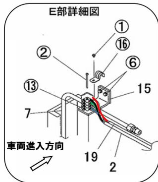
コントロールチューブ 接続詳細図
