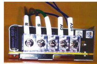
②新しい部品を、制御ボックス内の適当な位置に取付ネジ穴を追加して固定してください
