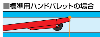
標準用ハンドパレットの場合 フォーク先端が干渉する
