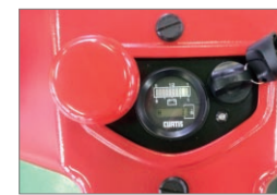
バッテリー残量がひと目でわかるインジケータ付き
